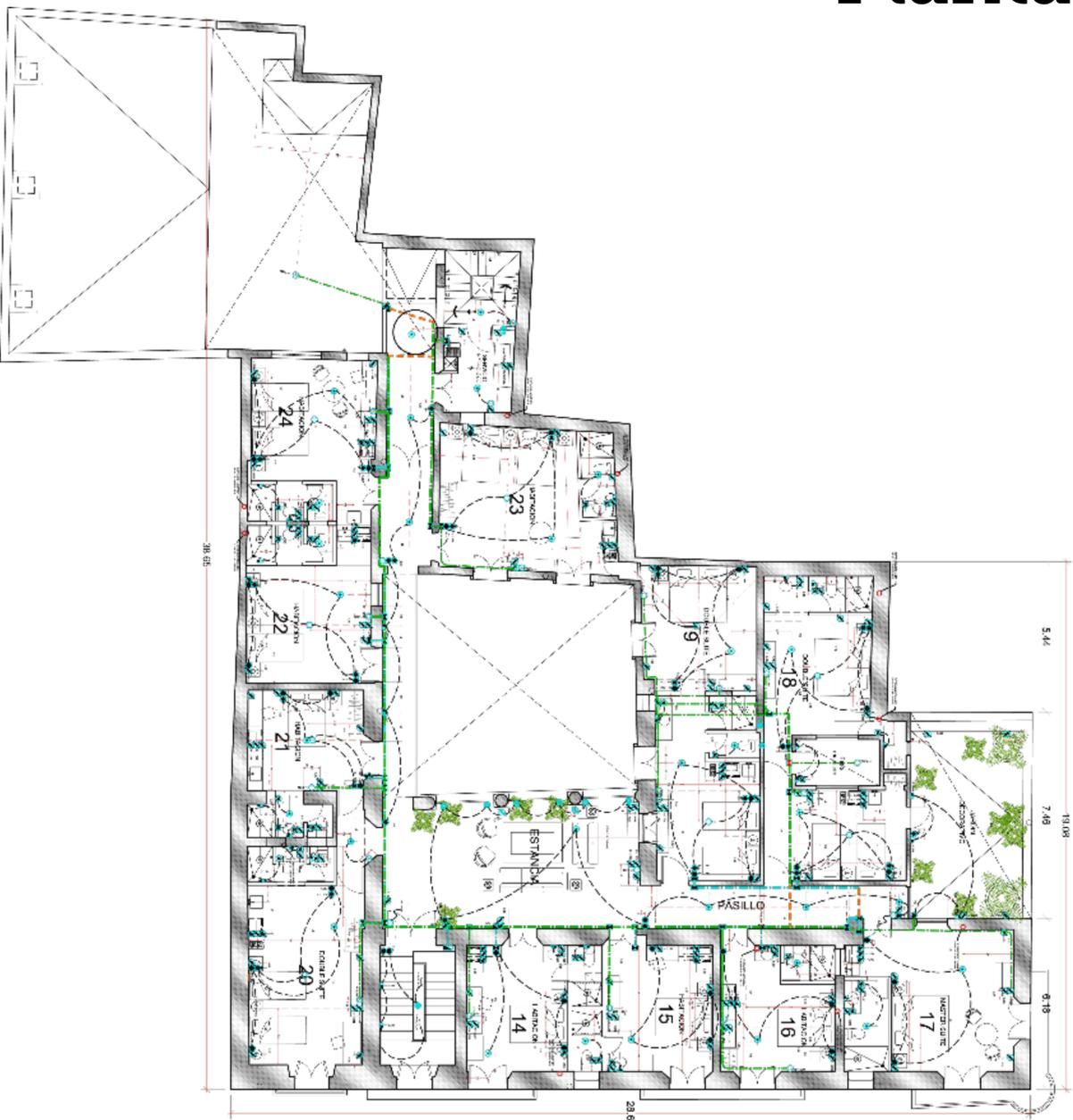
Se realizaron 3 circuitos generales: planta baja, planta alta y cuarto de bombas. Cada uno con su centro de carga separado con pastillas térmicas, alimentados por 1 medidor bifásico por calle Galeana y 1 medidor monofásico por calle Prisciliano Sánchez.
